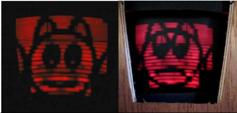
F1: La mire "FELIX THE CAT", utilisée par RCA en 1928, reconstituée et vue au standard C260, avec et sans ébénisterie.( échelle 1 )
